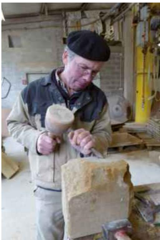
Fig. 16 : Tailleur de pierre avec son maillet en bois et le ciseau à pointe préparant une pièce selon son épure réalisée à l'échelle sur base d'un calepin d'appareil indiquant le gabarit, les formes et ornements de chaque pierre. Le tracé sur la pierre se fait au crayon avec la règle, l'équerre et le compas. Le contrôle de la taille se fait avec l'épure. Peter Weinand, Carrières Feidt, Ernzen.
