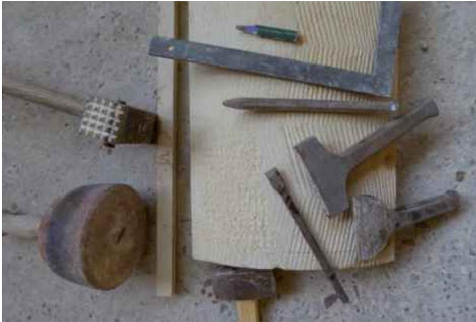
Fig. 20 : Outils de tailleur de pierre: crayon, équerre, latte, maillet et massette, ciseau à pic, ciseau droit et boucharde placés sur une pièce travaillée, décorée avec cisaillement large, préparation d'une ciselure d'encadrement pour le bouchardage. Peter Weinand, Carrières Feidt, Ernzen
