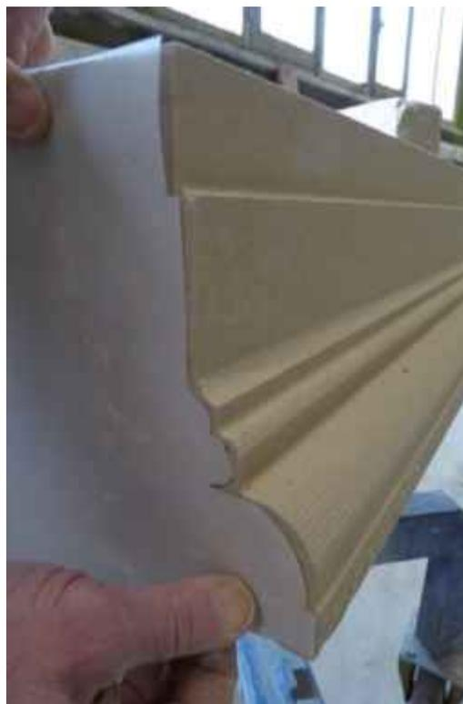
Fig. 17 : Épure sur calque placée sur une pièce travaillée machinalement par fraise et par ordinateur pour contrôle et finition. Peter Weinand, Carrières Feidt, Ernzen
